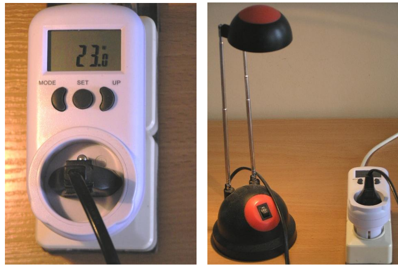
Rys. 5. Pomiar mocy lampy biurkowej za pomocą watomierza
