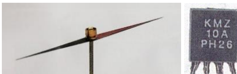
Rys.5. Igła magnetyczna i stosowany w naszym ćwiczeniu czujnik magnetorezystancyjny KMZ10A firmy Philips o wymiarach 4.8x5.2x1.8mm
