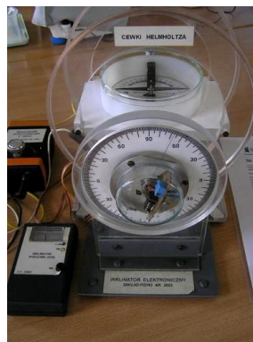
Rys.2. Po lewej: busola stycznych i cewki Helmholtza. W środku – inklinator ustawiony równoległe do kierunku północ-południe i równoległe do cewek Helmholtza. Po prawej – opis inklinatora
