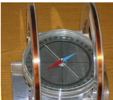
Rys.2. Po lewej: busola stycznych i cewki Helmholtza. W środku – inklinator ustawiony równoległe do kierunku północ-południe i równoległe do cewek Helmholtza. Po prawej – opis inklinatora
