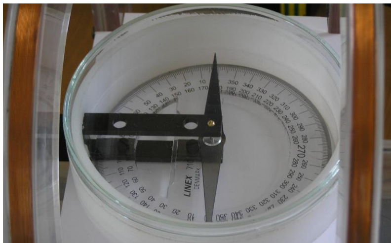
Rys. 17. Busola używana w ćwiczeniu. Po obu stronach busoli widoczne są uzwojenia kół Helmholtza
