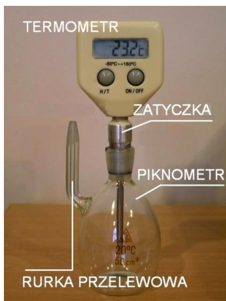
Rys. Aparatura do pomiaru współczynnika rozszerzalności objętościowej cieczy
