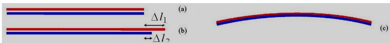
Rys.7. Zasada działania czujnika bimetalicznego. Dwa kolory oznaczają różne metale. Temperatura T_b > T_a , T_c > T_a .
