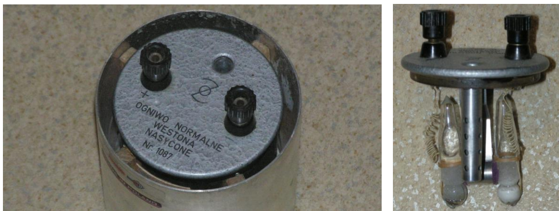
Rys.6. Ogniwo Westona (ZF UR). Otwór w obudowie służy do umieszczenia termometru
